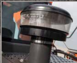
Luchtfilter van het cycloon-type
